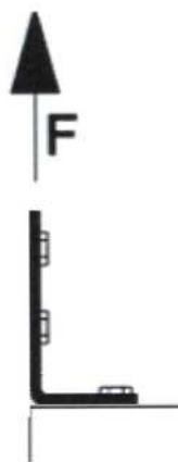
**Rys. C11. Schemat działania sił (dot. tablicy B71)****Tablica C71. Nośność obliczeniowa przegubu JOI 41 T HCP**
